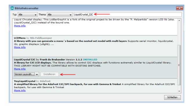
Sobald die Bibliothek installiert ist, ist die Installation des Displays abgeschlossen. Sie können nun im nächsten Schritt unseren Beispielcode übertragen, um das Display zu testen.
