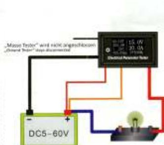
„Masse Tester“ wird nicht angeschlossen
